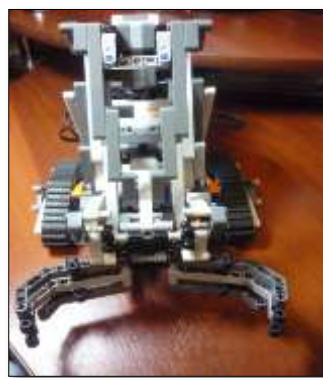
Рис.2.- Способ захвата мусора осуществляется механическими «пальцами» и по своей сути аналогичен работе человеческой руки.
